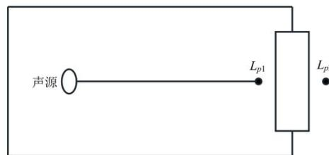
图 4-8 室内声源等效为室外声源图例
