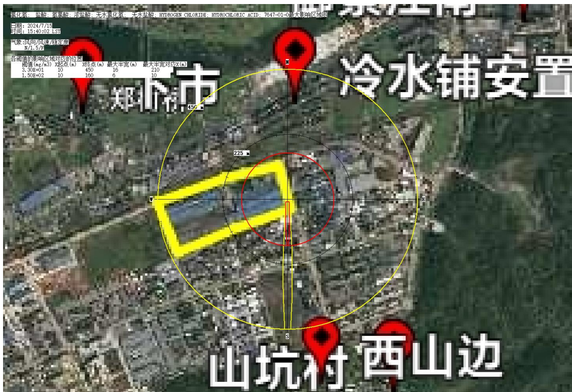
图 4 最不利气象条件盐酸泄露 (HCl) 预测结果图 (最大影响范围示意图)
