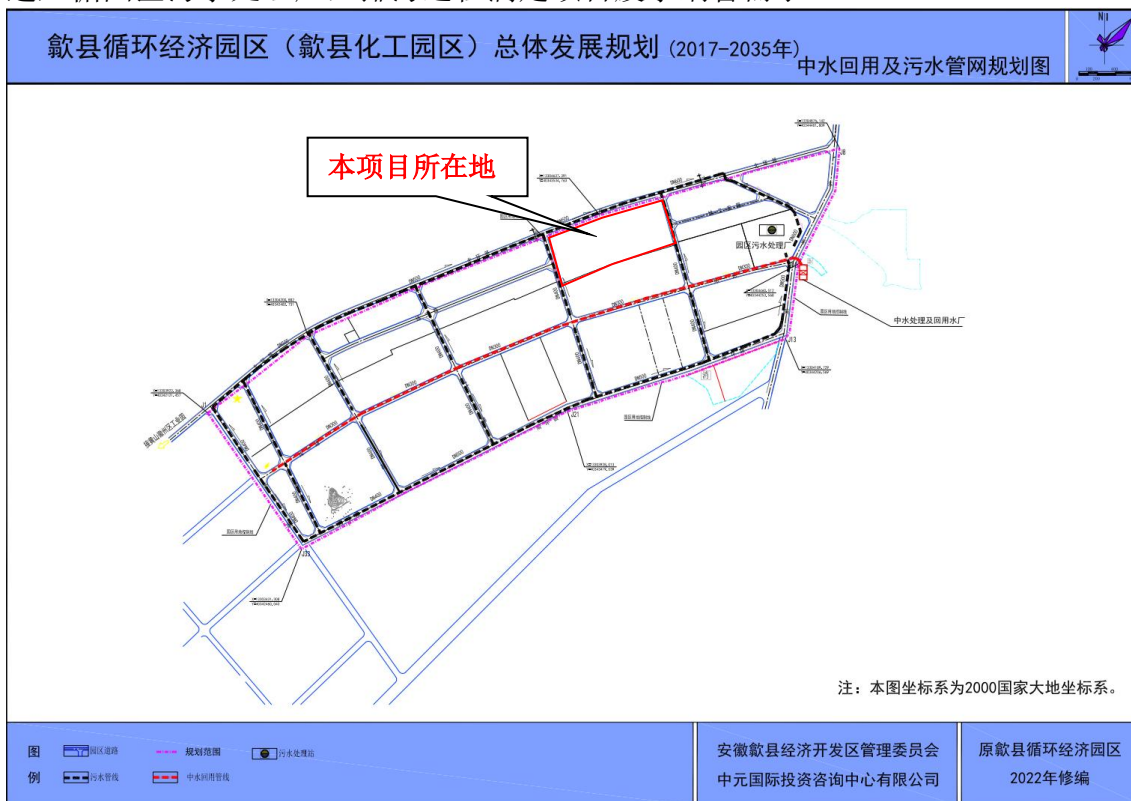
图 4-2 歙县循环经济园区污水管网规划图
